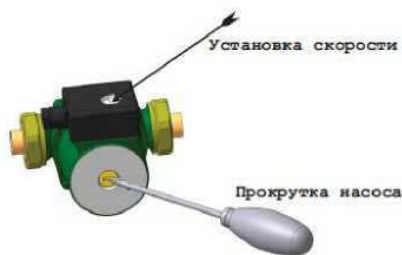
Рисунок 8. Схема прокрутки насоса
