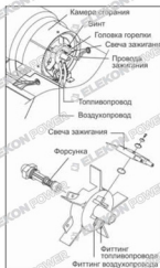
Рис. 16. Снятие форсунки
