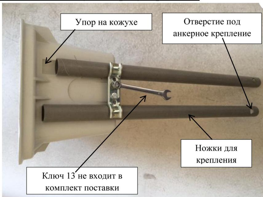
Вставить 4 ножки для крепления в верхний упор на кожухе. Плоским 13-мм ключом прикрепите ножки к кожуху. Отверстия на ножках предназначены для анкерного крепления с помощью строительного раствора/бетона. Нижняя часть кожуха располагается на дренирующей насыпи. Верхняя часть (кожух) должна быть закреплена на тротуаре (др. поверхности).
