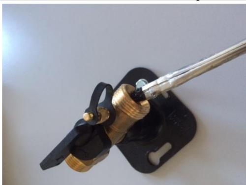
При помощи кисти смазать внутреннюю поверхность шарового крана используя соответствующую смазку (например: смазку MolyKote 1102 либо аналог)
