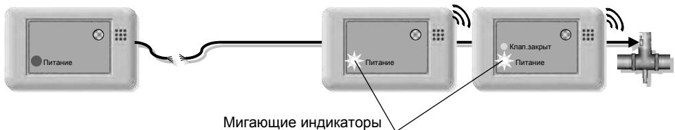
Рисунок 3 – Реакция Системы на обрыв кабеля
