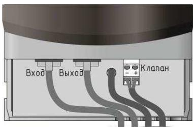
Рисунок 6 – Расположение разъемов в клеммном отсеке
