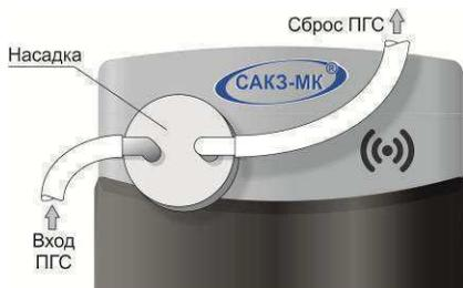
Рисунок Ж.1 – Установка насадки для подачи ПГС
