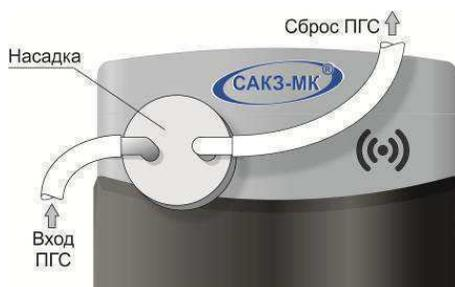
Рисунок И.1 – Установка насадки для подачи ПГС
