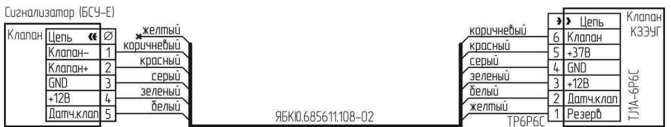
Рисунок Б.8 – Схема подключения клапана КЗЭУГ с разъемом TJ1A-6P6C
