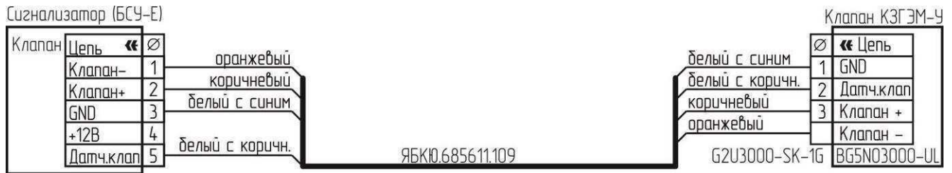
Рисунок Б.6 – Схема подключения клапана КЗГЭМ-У с разъемом BG5N03000-UL
