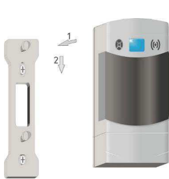
Рисунок Д.3 – Установка сигнализатора на монтажную панель
