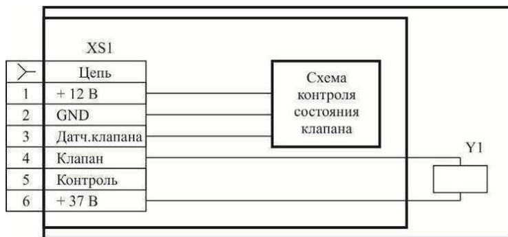
Рисунок 8 – Клапан КЗГЭМ-У. Схема электрическая принципиальная.
