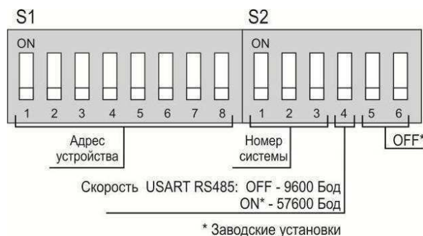
Рисунок 16 – Ретранслятора Р-433. Расположение переключателей.
