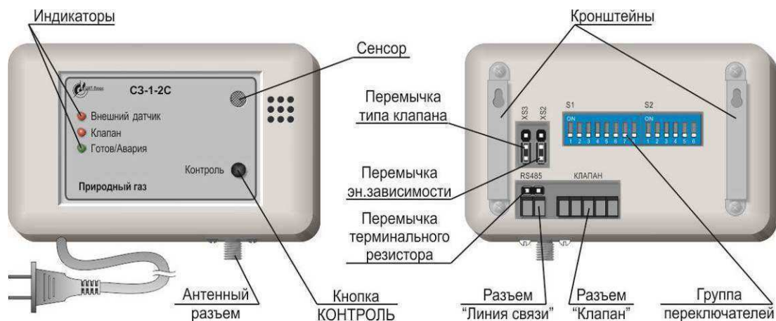
Рисунок 3 – Внешний вид сигнализатора.
