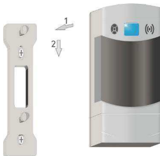
Рисунок Д.4 – Установка сигнализатора на монтажную панель
